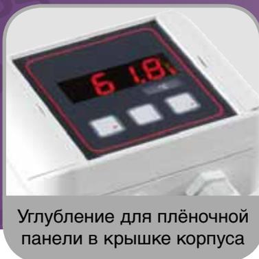
Углубление для плёночной панели в крышке корпуса
